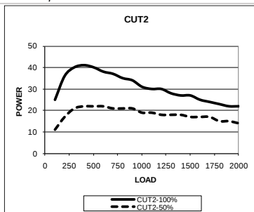
Diagramy polovičního a maximálního výstupního výkonu v závislosti na impedančním zatížení 100-2000Ω CUT2
